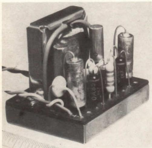
Fig. 2 - Realizzazione pratica del convertitore CC/CC da 900 mW
