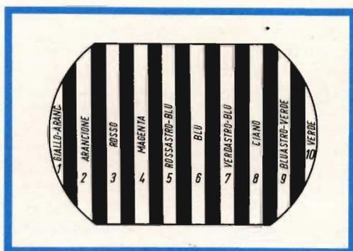
Fig. 7 - Rappresentazione in bianco e nero delle barre del colore sullo schermo del cinescopio tricromatico.
