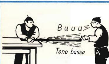
Se le oscillazioni sonore si ripetono molte volte nell'unità di tempo, il nostro orecchio percepisce un suono acuto; se invece nell'unità di tempo si hanno poche oscillazioni, il suono percepito sarà basso. La cosa si può facilmente dimostrare con un listello metallico tenuto fisso ad una estremità: se la parte di listello in oscillazione è relativamente lunga, le oscillazioni saranno lente e il suono sarà cupo.
