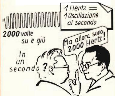
Il numero di oscillazioni sonore al secondo viene chiamato dai tecnici e dai fisici « frequenza ». L'unità della frequenza è l'hertz: 16 hertz significa 16 oscillazioni al secondo, 2000 hertz significa 2000 oscillazioni al secondo.
